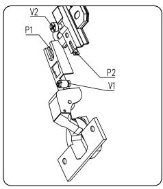
Канавка винта V1 должна войти в паз P2 планки, паз петли P1 должен войти под головку винта V2
